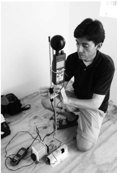
Figura 4 Instalación de anemómetro en punto HAB.
